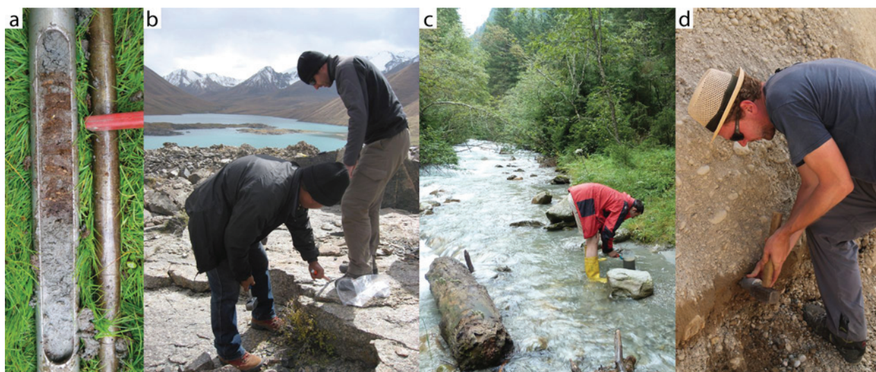
Abb. 10: Probennahme im Gelände. a) Organisches Material (Torf) in einem Bohrkern, das mithilfe der Radiokohlenstoffmethode datiert werden kann. b) Beprobung eines Felsblockes für die Oberflächenexpositionsdatierung großer Massenbewegungen im Tian Shan mithilfe kosmogener Nuklide (Sanhueza-Pino et al. 2011; Foto: J. Weidinger). c) Entnahme einer Flussandprobe für die Ermittlung einzugsgebietsweiter Denudationsraten. d) Entnahme einer lichtgeschützten OSL-Probe mit einem Stechzylinder.
