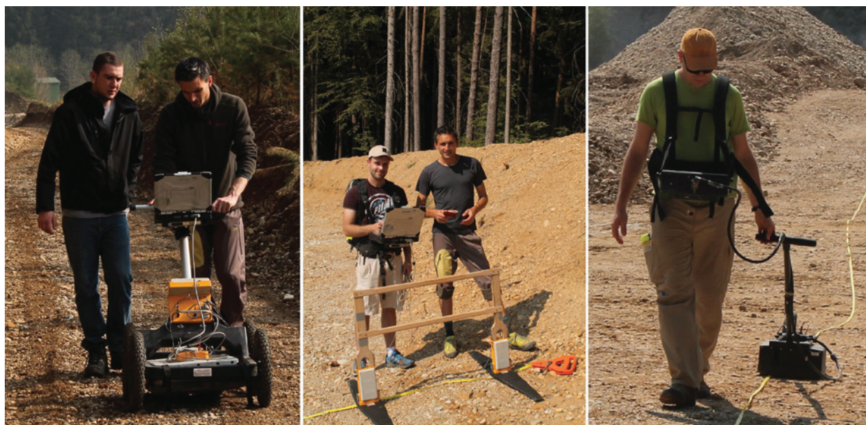
Abb. 6: Durchführung einer Georadarmessung mit Salzburger Studierenden der Geographie und Geologie. Drei unterschiedliche Systeme sind dargestellt. Links: Geschirmtes GPR System (250 MHz); Mitte: Ungeschirmtes System (100 MHz); Rechts: Geschirmtes System (200 MHz). Sende- und Empfangsantennen werden entlang des Maßbandes über die Oberfläche gezogen. Die Datenaufzeichnung erfolgt PC-gestützt.
