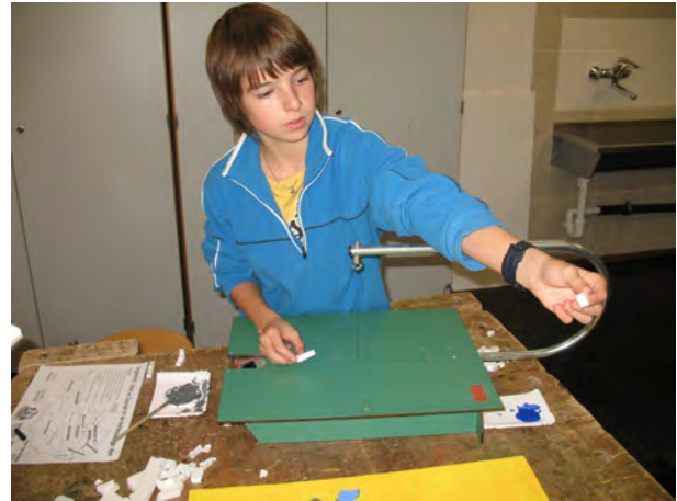
Abb. 4: Mit Hilfe einer Thermosäge werden die Bausteine für die einzelnen Schichten genau zugeschnitten.
