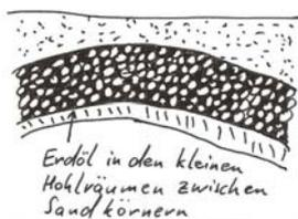
Dieses Vorstellungsmodell entspricht den wissenschaftlichen Modellen, die auf der Basis entsprechender Bohrkerne von Speichergestein, das sind in der Regel ölhältige Sandsteine oder poröse Kalke, entwickelt wurden. Bei der zeichnerischen Darstellung von Speichergesteinen wird Erdöl und manchmal auch Erdgas zwischen Sandkörnern oder in porösem Gestein befindlich dargestellt. Entsprechende Beschriftungen verdeutlichen dies.
